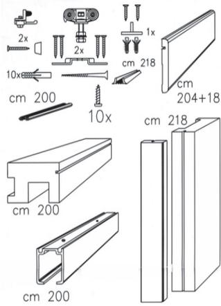
El kit permite la colocación de cualquier puerta corredera a la vista y paralela a la pared. La puerta queda suspendida de una guía compuesta por un travesaño de madera con carril de aluminio, rematado con un cubreguías de madera. Se puede adaptar la puerta que actualmente se tenga aunque sea abatible, adaptando la misma a corredera, o con una nueva. El resultado es una solución práctica y estética de rápida y fácil ejecución sin obras al alcance de cualquiera.
